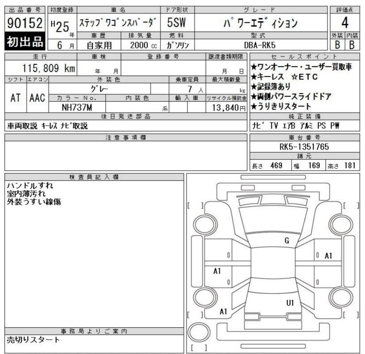
A:キズ U:ヘコミ B:セズを伴うヘコミ P:要塗装 W:補修跡 S:鎬 C:腐食、穴 G:フロントガラス点キズ XX:交換済み X:要交換 欠:欠品 内・外装評価 5段階ランク順(A・B・C・D・E) 2
